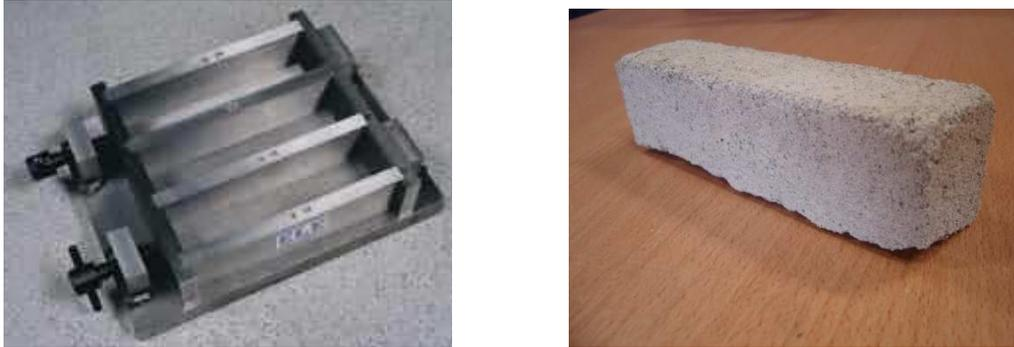
Figure 3.4. Moules prismatiques et éprouvette de mortier
