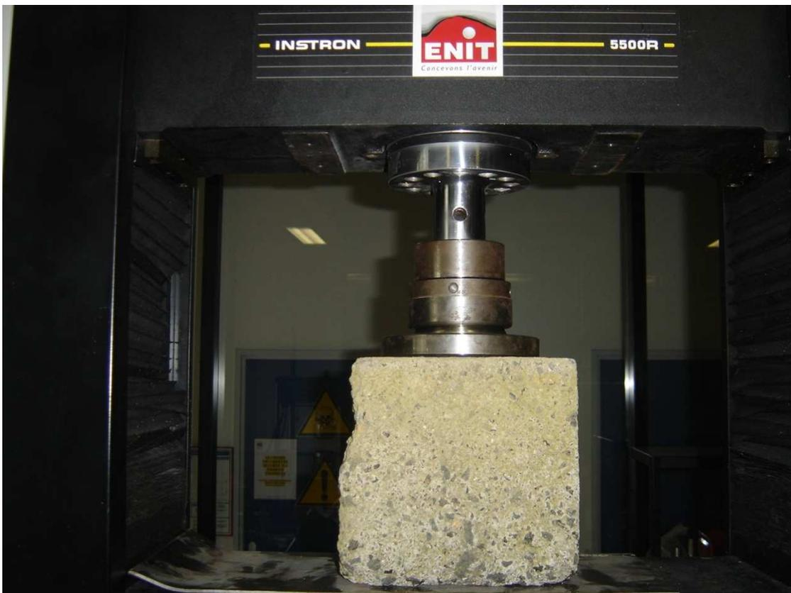
Figure 3.3. Essai de compression réalisé sur un bloc de parpaing plein
