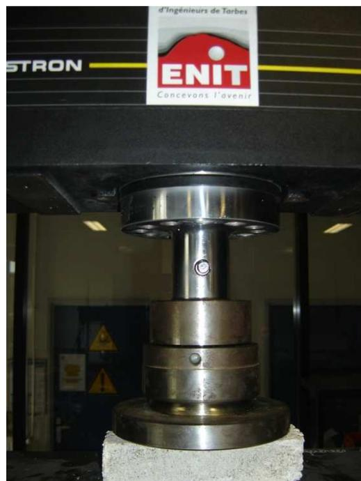
Figure 3.5. Essai de compression réalisé avec un mortier de chaux
