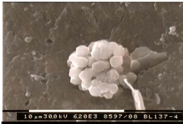
Figure 14. Pyrite framboïdale pouvant occasionner des risques de réaction sulfatique. Microscopie électronique à balayage (x6200)
