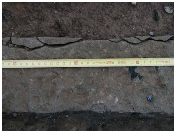
Figure 16. Pavé gelé dans les conditions naturelles.
