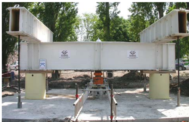
Figure 38. Dispositif d'essai pour le chargement d'un micropieu
