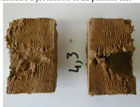
Figure 31. Éprouvettes après essais à l'érodimètre à jet mobile et au pinhole test
