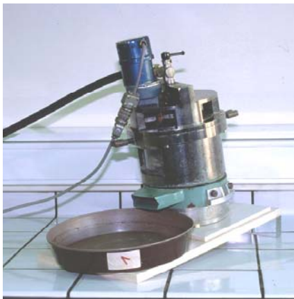
Figure 30. Matériel d'essais de l'érodimètre à jet mobile et du pinhole test
