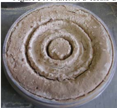
Figure 31. Éprouvettes après essais à l'érodimètre à jet mobile et au pinhole test
