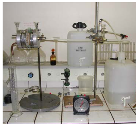
Figure 30. Matériel d'essais de l'érodimètre à jet mobile et du pinhole test
