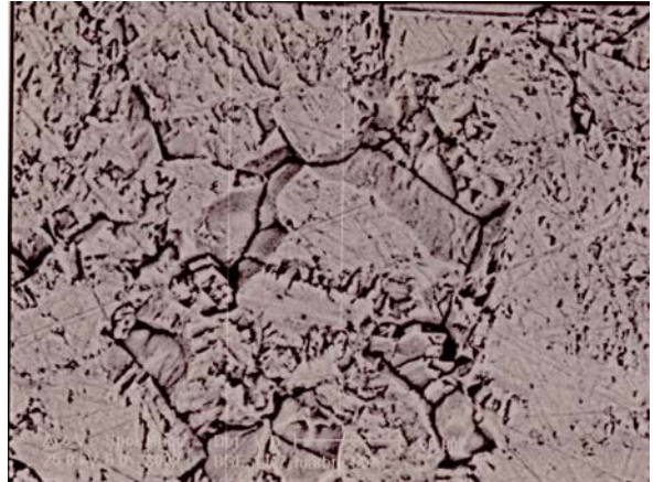
Figure 20. Marbre fissuré par l'action de la chaleur. Microscopie électronique à balayage (x500)
