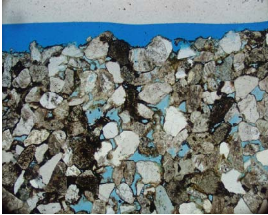
Figure 19. Grès poreux non adapté à une utilisation en dallage. Microscopie optique (x50)
