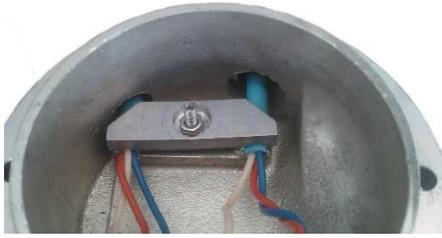
La tresse de masse est enroulée autour de la gaine. Le pontet mécanique la maintient en position et réalise le contact électrique.
