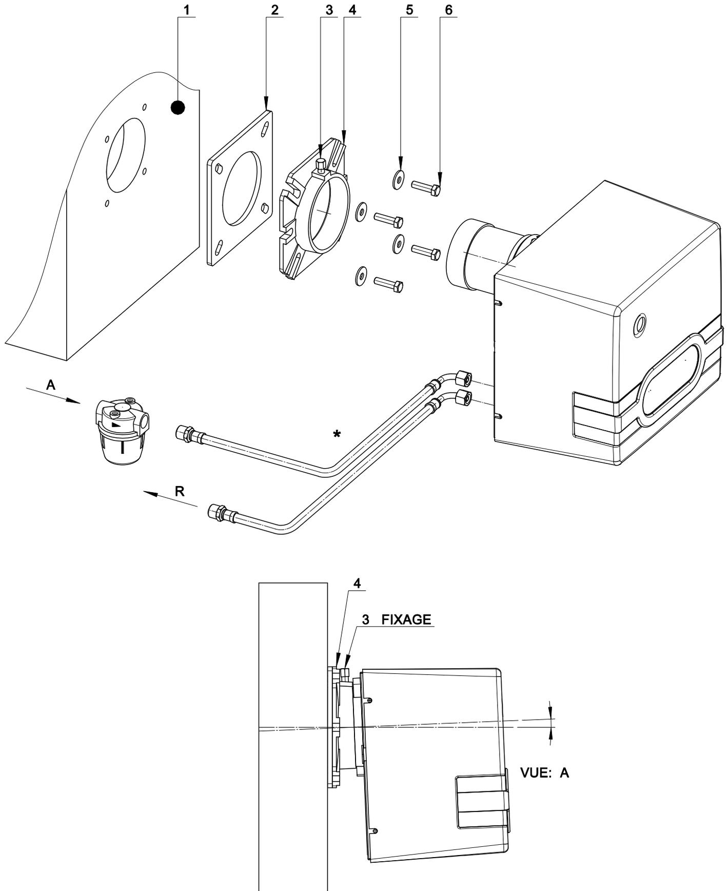
Fixer à la porte de la chaudière (1) la bride (4) par les rondelles (5) et les vis (6), interposant l'écran isolant (2). Successivement positionner le brûleur en appui à la bride (4) et serrer la vis (3), à l'installation arrivée vérifier que le brûleur soit incliné légèrement comme en vue A.
