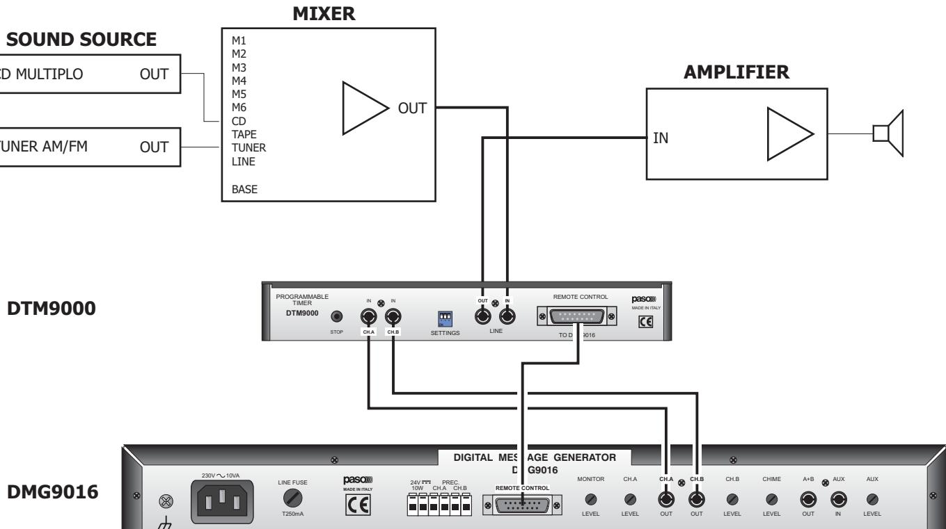
Met dit type aansluiting wordt, wanneer de berichten worden gereproduceerd, die vooraf en ook weer met vastgestelde tijdsleuven, instelbaar met de timer DTM9000, zijn opgenomen, de achtergrondmuziek tijdelijk onderbroken. Aan het eind van het bericht, gaat de muziek weer aan, in afwachting van het volgende bericht.
