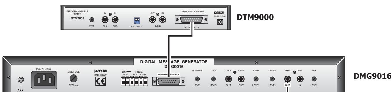
Avec ce type de branchement, les messages préenregistrés sont reproduits à des intervalles de temps déterminés qui peuvent être réglés à l'aide du temporisateur DTM9000.
