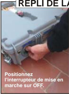
Positionnez l'interrupteur de mise en marche sur OFF.
