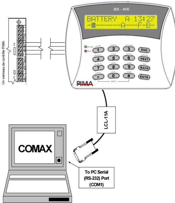
**Illustration 14 – Connexion du LCL-11A au clavier du client**
