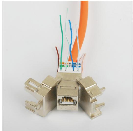
4. Emboîter fermement le couvercle de maintien sur le connecteur afin d'enfoncer complètement les fils dans les interstices.
