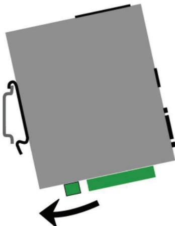
Pour démonter le produit du rail Din 35 mm,
