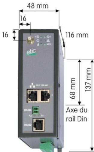
La hauteur indiquée ne tient pas compte de l'encombrement du connecteur débrochable d'alimentation de la face inférieure.
