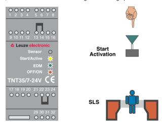
Figure 5.4-4: Affichage de la TNT 35/7-24V lors d'une interruption de la zone de protection
