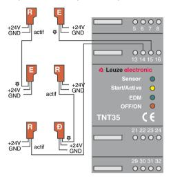
Figure 4.2-5: Câblage de cellules photoélectriques de sécurité à faisceau unique en série
