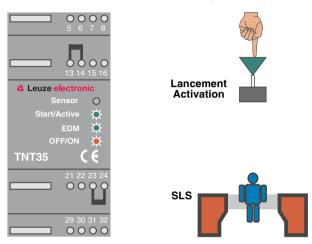
Figure 4.3-3: Affichage de la TNT 35 lors d'une interruption de la zone de protection
