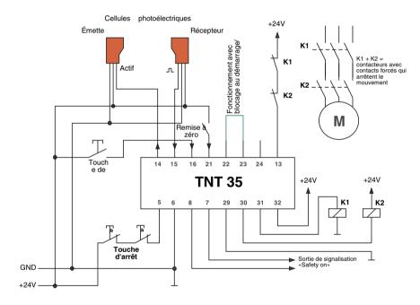
**Figure 6.5-1:** Schéma de raccordement avec cellule photoélectrique de sécurité SLS 96 et fonction d'arrêt d'urgence
