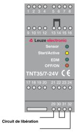
Figure 5.2-6: Câblage de la sortie de sécurité (circuit de libération à voie unique)
