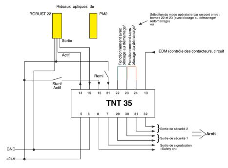
Figure 6.4-1: Schéma de raccordement pour le branchement d'un ROBUST 22
