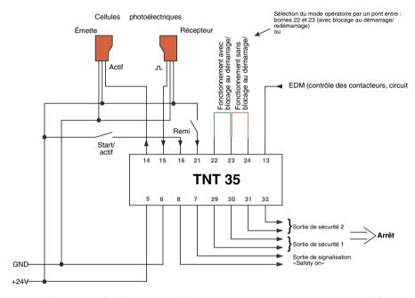
Figure 6.2-1: Schéma de raccordement pour le branchement d'une paire de SLS 96
