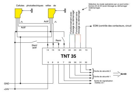
Figure 6.1-2: Schéma de raccordement pour le branchement de deux SRK 96
