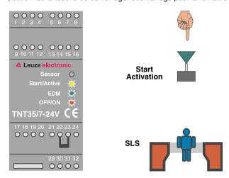
Figure 5.5-4: Affichage de la TNT 35/7-24V lors d'une interruption de la zone de protection
