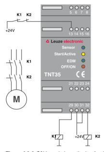
Figure 4.2-8: Câblage de la sortie de sécurité avec contrôle des contacteurs
