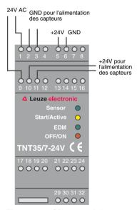
Figure 5.2-1: Câblage de l'alimentation
