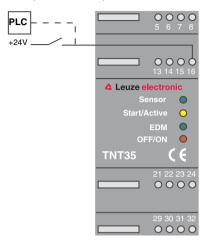
Figure 4.2-3: Câblage de l'entrée Start «sans blocage au démarrage et au redémarrage»
