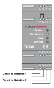
Figure 4.2-7: Câblage de la sortie de sécurité (circuit de libération à deux voies)
