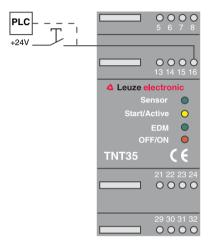
Figure 4.2-2: Câblage de l'entrée Start «avec blocage au démarrage et au redémarrage»
