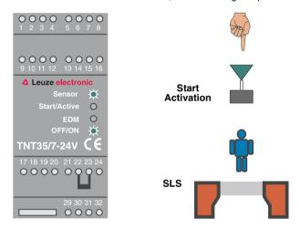
Figure 5.5-3: Affichage de la TNT 35/7-24V en mode de protection
