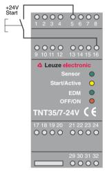
Figure 5.2-2: Câblage de l'entrée Start «avec blocage au démarrage et au redémarrage»
