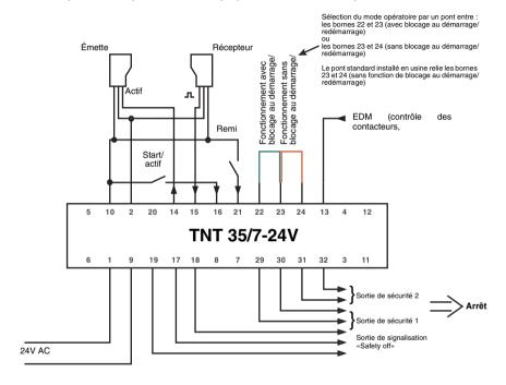
Figure 5.1-1: Structure du système complet de sécurité
