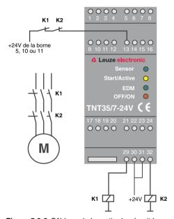
Figure 5.2-8: Câblage de la sortie de sécurité avec contrôle des contacteurs
