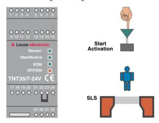
Figure 5.5-2: Affichage de la TNT 35/7-24V en mode de test
