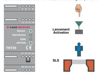
Figure 4.5-3: Affichage de la TNT 35 en mode de protection
