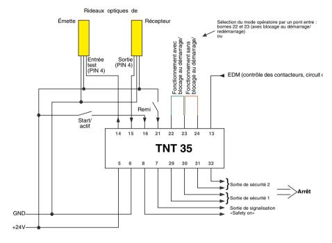
Figure 6.3-1: Schéma de raccordement pour le branchement d'une paire ECO
