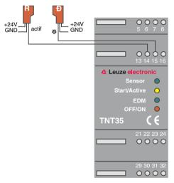
Figure 4.2-4: Câblage de cellules photoélectriques de sécurité à faisceau unique
