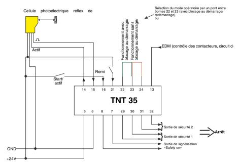
Figure 6.1-1: Schéma de raccordement pour le branchement d'une SRK 96
