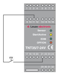
Figure 5.6-1: Ouverture du verrouillage
