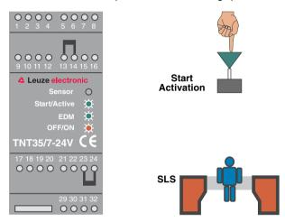
Figure 5.3-3: Affichage de la TNT 35/7-24V lors d'une interruption de la zone de protection
