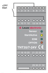
Figure 5.2-3: Câblage de l'entrée Start «sans blocage au démarrage et au redémarrage»
