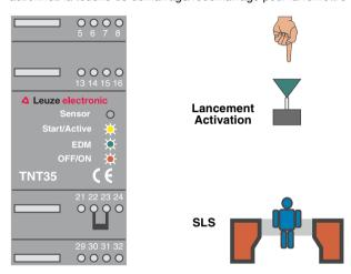
Figure 4.5-4: Affichage de la TNT 35 lors d'une interruption de la zone de protection
