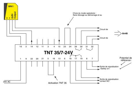
Figure 6.6-1: Schéma de raccordement pour le branchement d'une SRK 96
