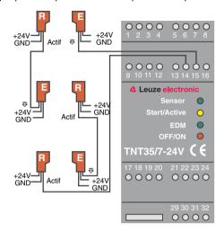
Figure 5.2-5: Câblage de cellules photoélectriques de sécurité à faisceau unique en série
