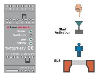
Figure 5.4-3: Affichage de la TNT 35/7-24V en mode de protection
