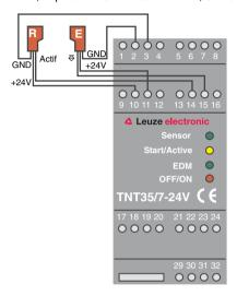
Figure 5.2-4: Câblage de cellules photoélectriques de sécurité à faisceau unique
