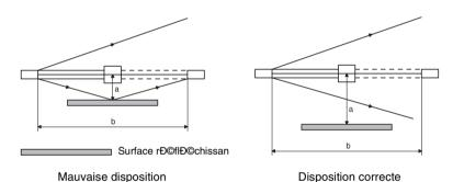
Figure 3.1-4: Déviation par réflexion
