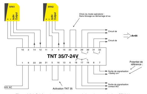
Figure 6.7-1: Schéma de raccordement pour le branchement de deux SRK 96
