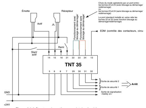
Figure 4.1-1: Structure du système complet de sécurité
