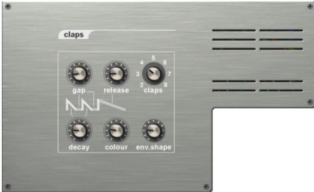
Gap (intervalle) détermine la durée des intervalles entre les impulsions de bruit.
