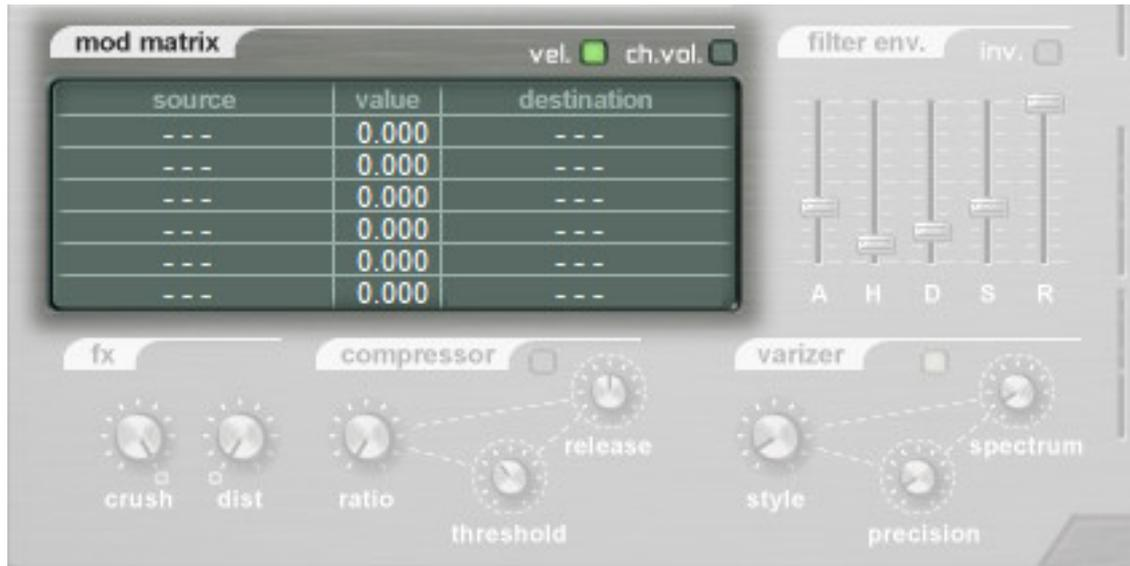
Les sources de modulation sont dans la colonne de gauche de la matrice alors que les destinations sont à droite. L'amplitude de la modulation est au milieu. Pour établir une modulation cliquez sur la source ou la destination. Un menu apparaîtra pour vous permettre de choisir la nouvelle source ou la nouvelle destination. Pour retirer une source ou une destination choisir la ligne « - - - » du menu. Les destinations qui sont suivies d'un « [S] » concernent le Sampleur de RMIV.
