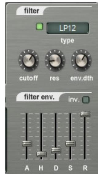
**Cutoff:** Cutoff représente la fréquence de coupure du filtre (en Hz). Elle a différentes significations en fonction du type du filtre. Pour en savoir plus consulter le Glossaire.
