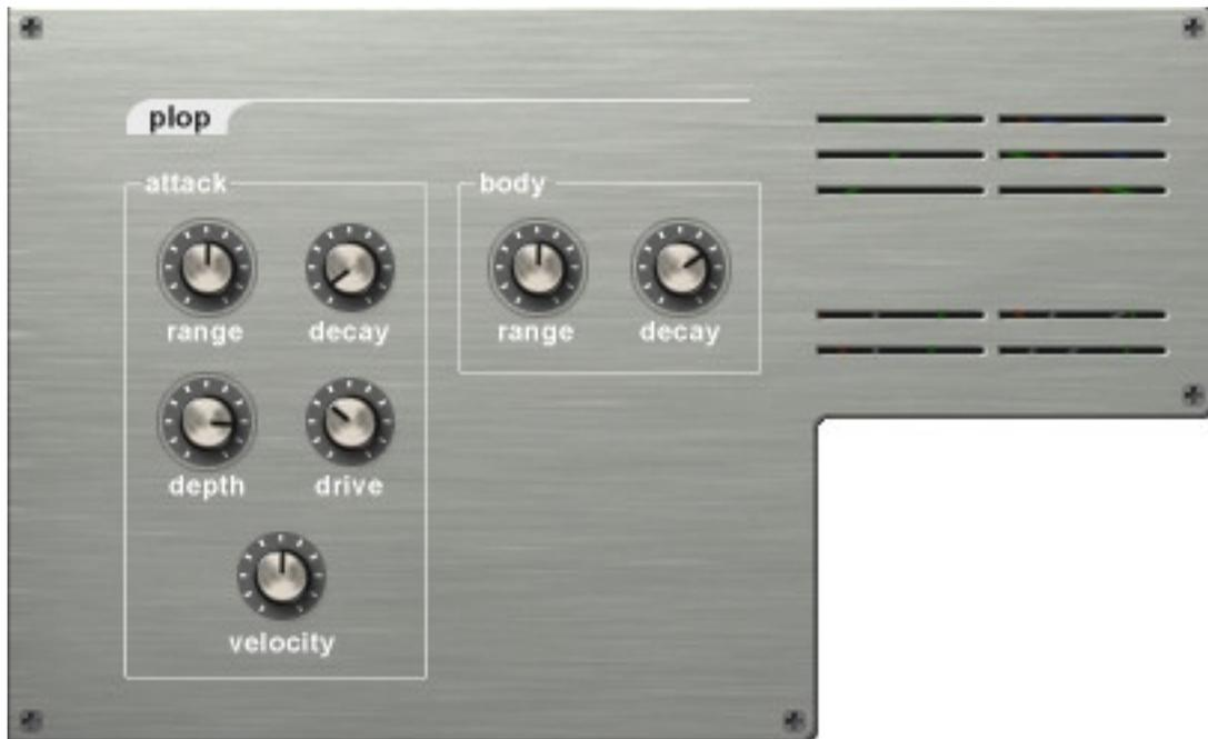
Attack Range (plage de l'attaque) agit sur la plage de fréquence de l'attaque du son. Elle est ajustée en relatif par rapport au paramètre Body Range (plage du corps du son).
