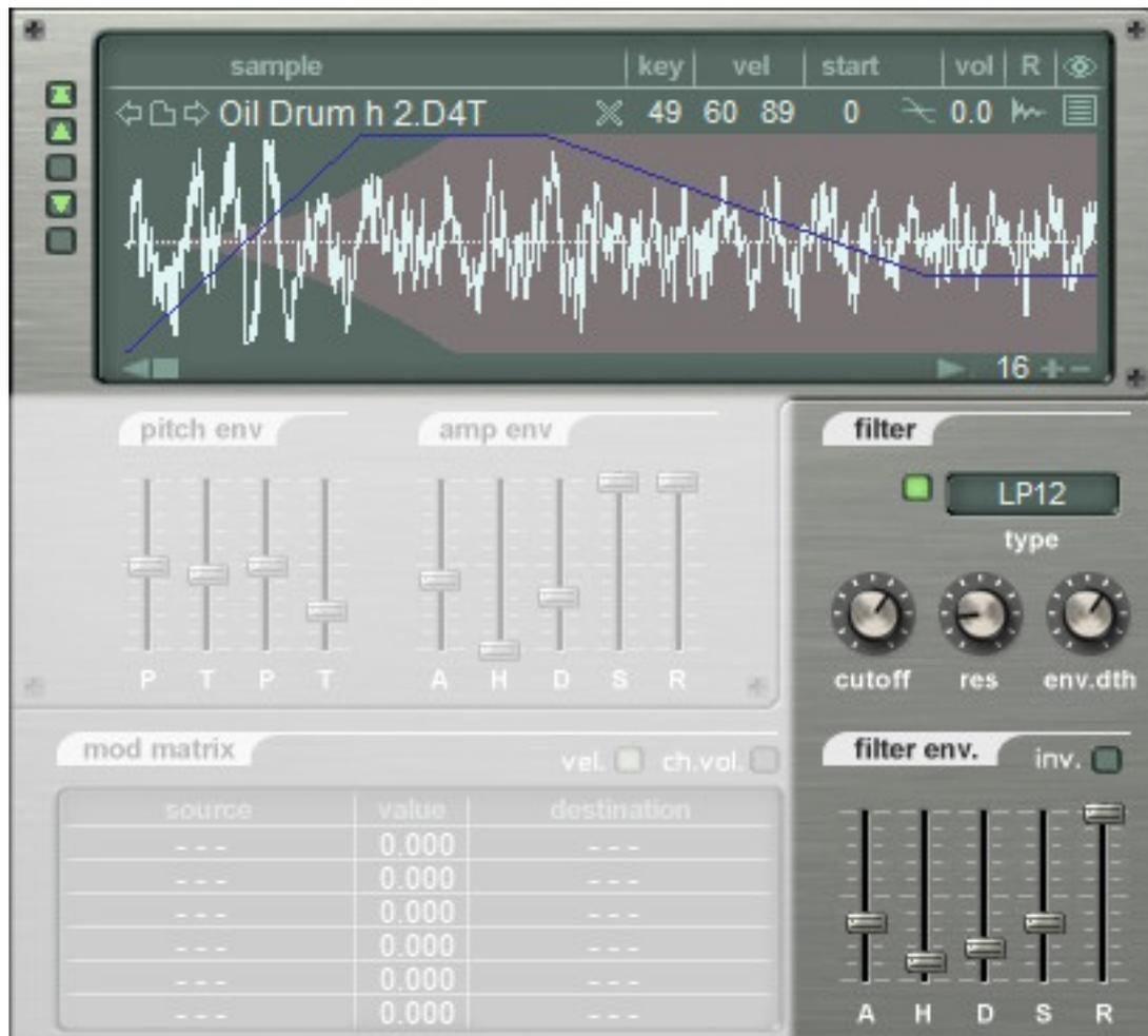
R(elease): Le potentiomètre R (Release (relâchement)) fixe le temps qu'il faut pour que la fréquence de coupure revienne à sa valeur initiale à partir du moment où la note est relâchée.
