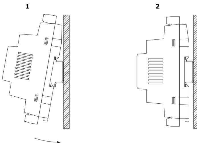
Pour retirer les dispositifs retirer d'abord tout bornier éventuel à vis extractibles insérés dans la partie basse, puis agir sur le clip du guide DIN avec un tournevis de la façon indiquée dans le dessin suivant.
