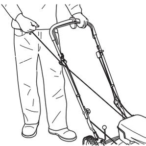
**REMARQUE!** Ne pas sortir complètement la corde du lanceur et ne pas lâcher la poignée avec la corde du lanceur complètement sortie. Cela pourrait endommager la machine.
