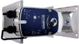
Le fonctionnement du clapet coupe-feu avec un servomoteur à ressort de rappel permet la commande à distance et/ou le déclenchement par un détecteur de fumée adapté.
