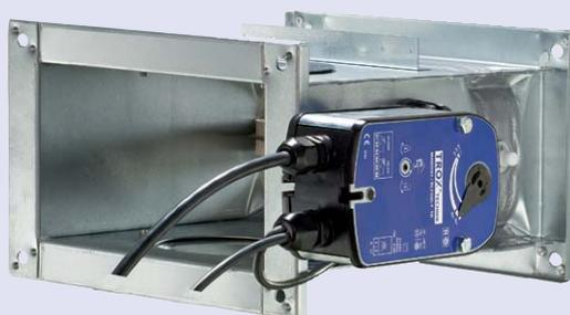
En cas d'incendie, les clapets coupe-feu se ferment automatiquement pour empêcher la propagation du feu et de la fumée dans les gaines vers d'autres compartiments d'incendie adjacents. Les clapets coupe-feu de type FKS-EU sont testés d'après la norme EN 1366-2 et sont conformes à la norme EN 15650.
