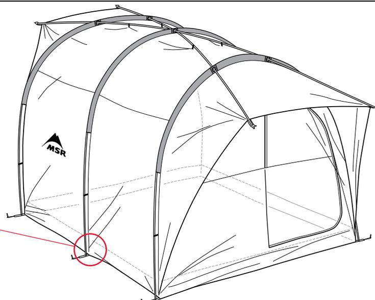
**Remarque :** Toutes les tentes doivent être ancrées avec des piquets, pour éviter qu'elles s'envolent avec le vent. Sous certaines conditions, des piquets et des cordages supplémentaires peuvent être nécessaires. Il peut être nécessaire de réajuster les piquets et le double-toit pour que la tente soit étanche. Un tapis de sol permet de garder votre tente propre, sèche et réduit l'abrasion. En respectant ces conseils, vous prolongerez la durée de vie de votre tente.
