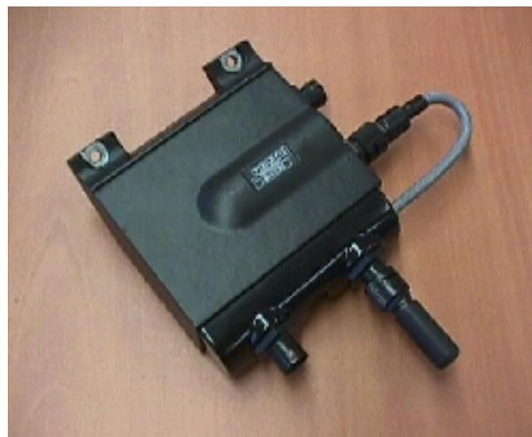
Cette option permet de contrôler le COMBIMASTER par un bus série PROFIBUS-DP (SINEC L2-DP).
