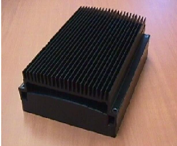
L'unité de freinage à résistance pulsée permet au COMBIMASTER de supporter de plus fortes surtensions ; elle peut être également utilisée pour fournir une puissance de freinage de 7kW maximum (crête) permettant d'arrêter le système plus rapidement.
