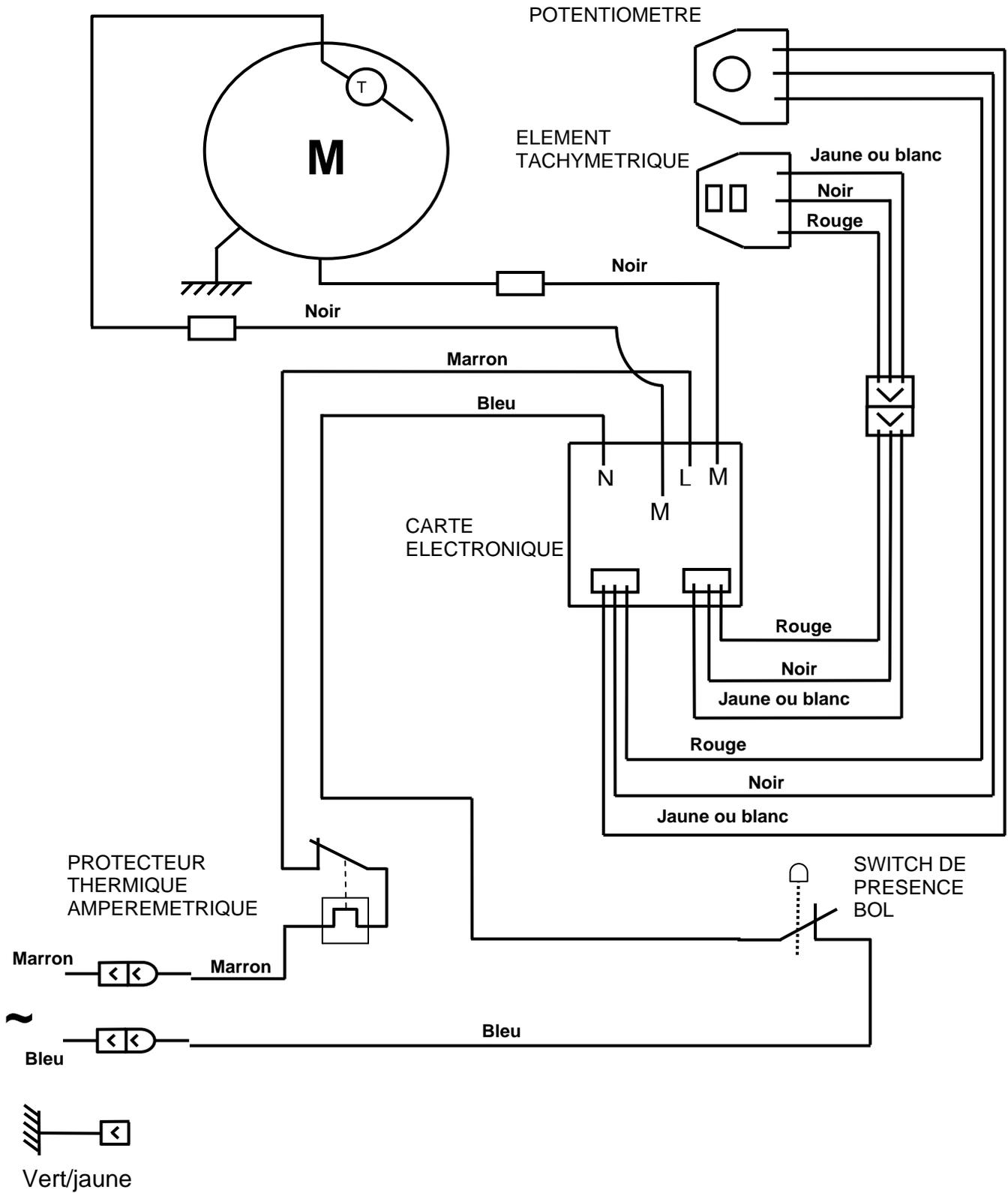
Schéma électrique 220-240V~ 50/60Hz
