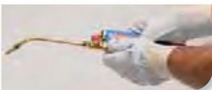
Ouvrir le robinet d'oxygène (bleu) du chalumeau jusqu'à l'obtention d'un léger débit. Si le débit est trop fort, la flamme sera soufflée.
