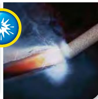
Soudage à l'arc à l'électrode
