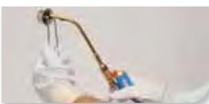
Allumer le chalumeau à l'aide d'un allume-gaz spécialement conçu.
