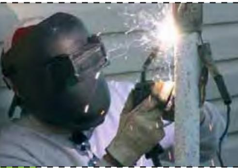
Proche du soudage à l'électrode enrobée, ce procédé se distingue par le recours à un fil continu et fusible qui remplit la fonction d'électrode. Il est couramment désigné par "semi-automatique" ou MIG/MAG dans l'univers industriel.
