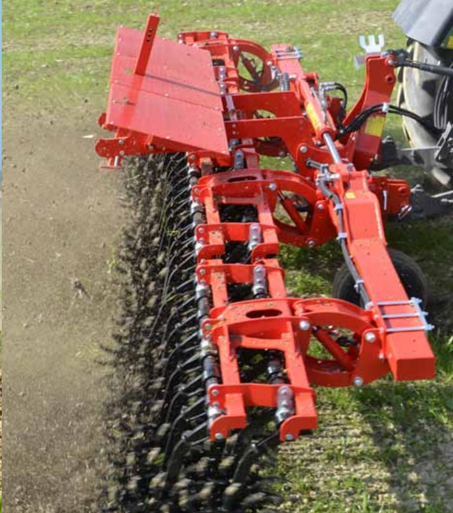
A travers le réglage hydraulique des parallélogrammes, on peut lors de l'utilisation faire varier la pression sur les houes. Ce système permet en plus de compenser la différence de niveau du terrain, ainsi on garde la même tension sur les ressorts et donc sur les houes.
