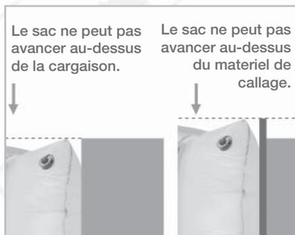
5. Le matériau doit s'étendre au-dessus de la cargaison.
