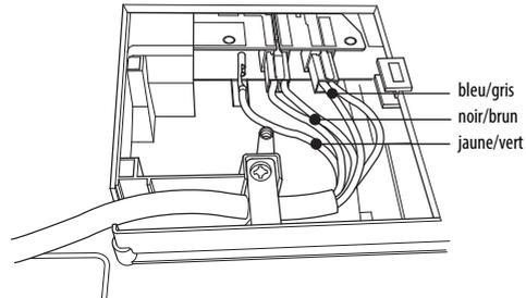
1. Retirez le cache-borne (A) en dévissant la vis et insérez le couvercle dans la charnière (B) du bloc de jonction.
