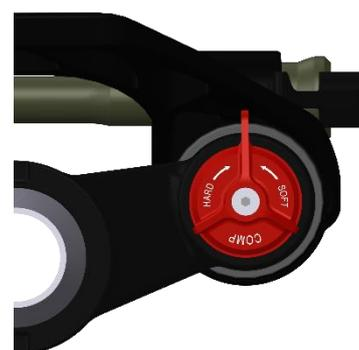
**Les fameuses trois positions** sont identifiées comme S (soft), M (medium) et H (hard). Les deux positions extrêmes S et H se réalisent par mise en butée du levier, soit vissé à fond, soit dévissé à fond. La position M est quant à elle assurée par un clic afin de positionner le levier rapidement et intuitivement pendant l'utilisation.
