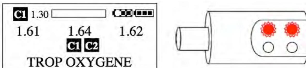
Messages visuels à destination du plongeur en cas de PpO<sub>2</sub>>1,6 : la console indique le problème tandis que le H.U.D clignote en rouge dans le champ de vision du plongeur. Le buzzer au niveau de l'oreille gauche du plongeur fait retentir un signal sonore.
