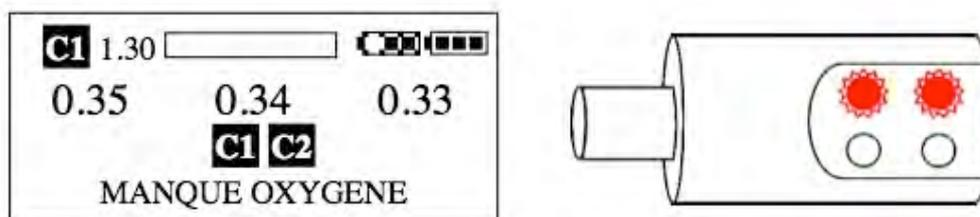
Messages visuels à destination du plongeur en cas de chute de la PpO<sub>2</sub> : la console indique le problème tandis que le H.U.D clignote en rouge dans le champ de vision du plongeur. Le buzzer au niveau de l'oreille gauche du plongeur fait retentir un signal sonore.
