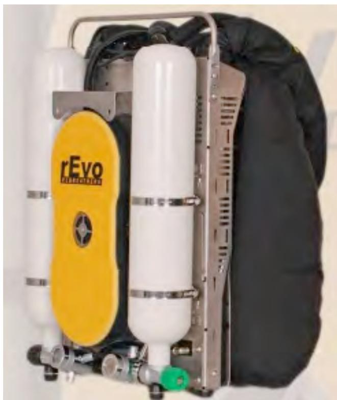
rEvo III : recycleur disponible en versions mCCR, hCCR ou eCCR. Les versions hCCR et eCCR viennent de recevoir en 2011 l'agrément CE pour la plongée avec un diluant air. Ce recycleur présente la caractéristique d'avoir deux canister disposés en série (derrière le couvercle jaune). Les faux poumons se situent en position dorsale et sont protégés par l'armature.
