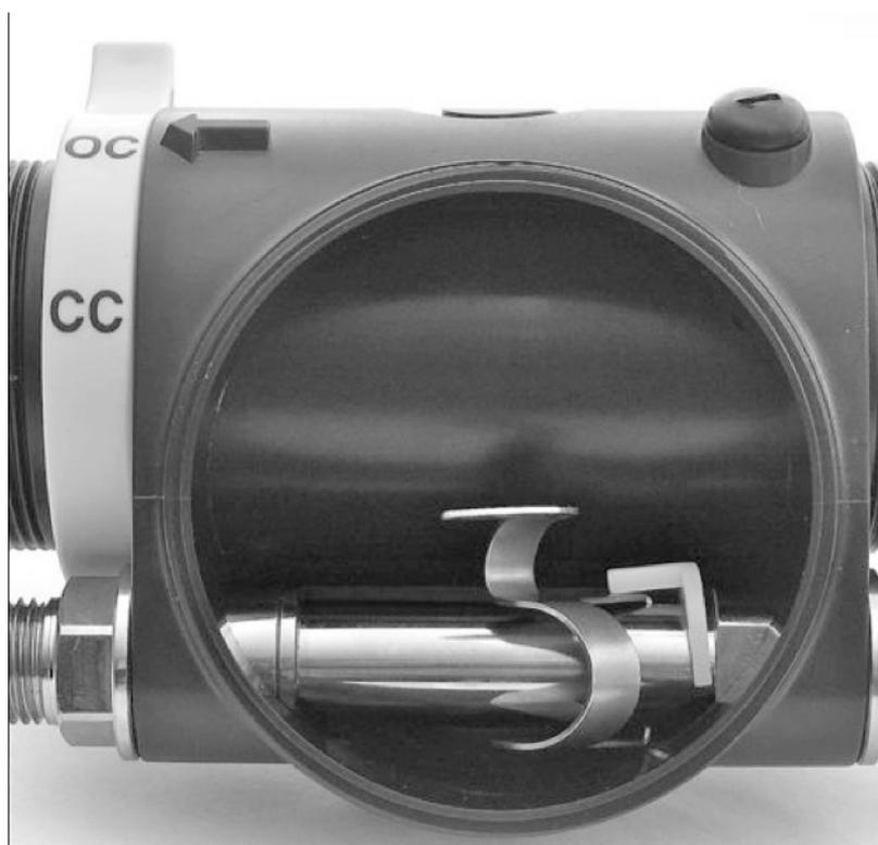
Schéma de l'O.C.B (*Open Circuit Bailout*) vendu en option par A.P.Diving. Le couvercle et la membrane de ce BOV ont été enlevés laissant apparaître le mécanisme similaire à un deuxième étage de détendeur. Le levier sur la gauche se positionne en mode CC (Closed Circuit) durant la plongée et peut être basculé en mode OC (Open Circuit) par le plongeur en cas de nécessité. L'embout est alimenté par une entrée UNF 9/16" classique (en bas à gauche).
