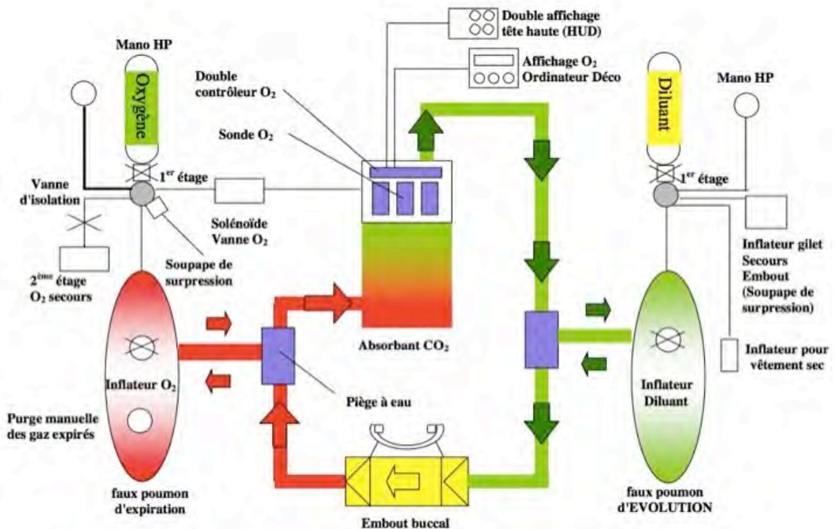
Schéma de principe du recycleur fermé électronique Evolution d'A.P. Diving.
