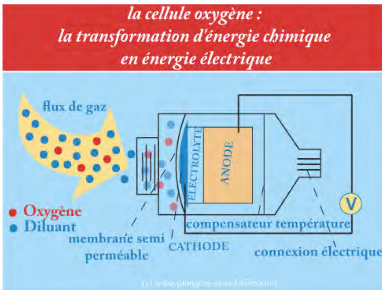
La tension en sortie de sondes varie avec la PpO<sub>2</sub>. Si la PpO<sub>2</sub> augmente, la tension augmente. La tension varie d'une sonde à l'autre, même lorsqu'elles sont exposées à la même PpO<sub>2</sub> et la pression atmosphérique varie continuellement. En conséquence, les sondes oxygène ont besoin d'être étalonnées avant chaque plongée afin d'appliquer un coefficient d'étalonnage qui leur permette de lire la bonne PpO<sub>2</sub>.
