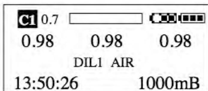
Exemple d'affichage en mode surface après paramétrage : la console indique le contrôleur maître en haut à gauche (C1), le setpoint utilisé (0,7b), le niveau d'utilisation de la chaux et le niveau des deux piles. En milieu d'écran on observe la valeur de la mesure de la PpO<sub>2</sub> pour chaque sonde (0,98b) ainsi que la nature du diluant. L'heure et la pression atmosphérique sont indiquées sur la ligne du bas.
