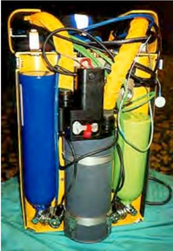
Photo du cis-Lunar MK4. On y retrouve tous les éléments des recycleurs électroniques modernes à savoir :
