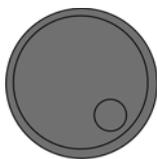
**La molette (double fonction rotation et appui)** permet de choisir le paramètre à modifier (par rotation), s'il s'agit d'une valeur numérique ou d'un nom de le sélectionner ou désélectionner (par appui) et de le modifier (par rotation). Elle peut être associée aux touches menu <- et -> pour sélectionner le chiffre ou la lettre à modifier.
