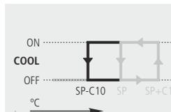
Lorsque ce mode est activé, le compresseur commence à fonctionner jusqu'à ce que la température dans la sonde 1 atteigne la valeur du point de réglage moins la variation indiquée dans le paramètre C10.
