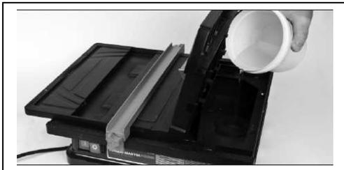
Avant utilisation, remplir le réservoir d'eau. Pour un résultat plus propre, utiliser suffisamment d'eau pour couvrir la jante du disque. Vérifiez fréquemment le niveau d'eau durant l'utilisation. Ne pas laisser le disque tourner à sec.
