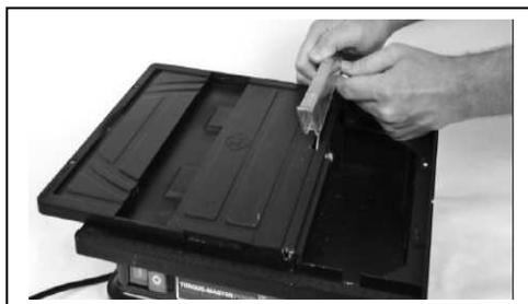
Fermer le plateau et placer le cache lame derrière la fente de sortie du disque. Ajuster la hauteur à votre convenance.
