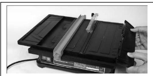
Positionner les crochets de la table d'extension dans les fentes sur le côté du corps principal du coupe carreau, et assurez-vous que la table est de niveau.
