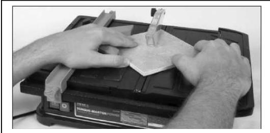
Resserrer le bouton et positionner le carreau entre la lame et le guide de coupe.
