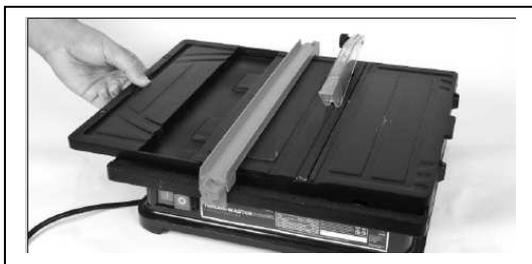
Mettre en marche la machine et couper le carreau avec le disque.
