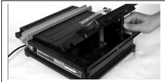
Positionner les pattes de levage dans l'emplacement prévu à cet effet, sur le bord intérieur du réservoir.
