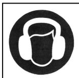
Si la machine est utilisée par le même opérateur de façon continue pendant 8 heures, elle peut entraîner une exposition quotidienne au bruit supérieure à 85 dB (A). Pour réduire les risques dérivant d'une telle exposition, il est recommandé de porter un casque antibruit prévu à cet effet. (non fourni)
