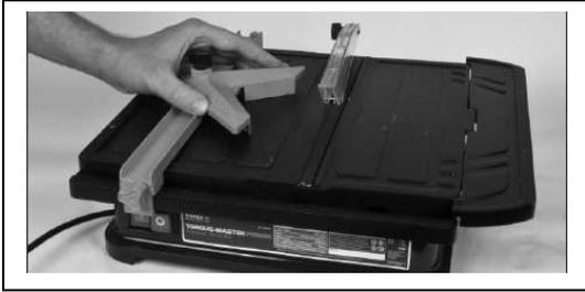
Relâcher le bouton de la partie en forme de losange et régler l'angle de coupe.
