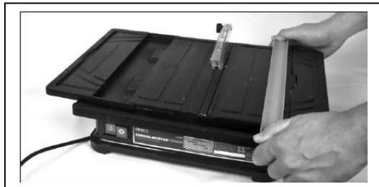
Placer le guide de coupe sur le plateau et le régler en alignant les graduations sur une rainure à la taille souhaitée. Lorsqu'il est correctement aligné, fixer le guide à l'aide des écrous.
