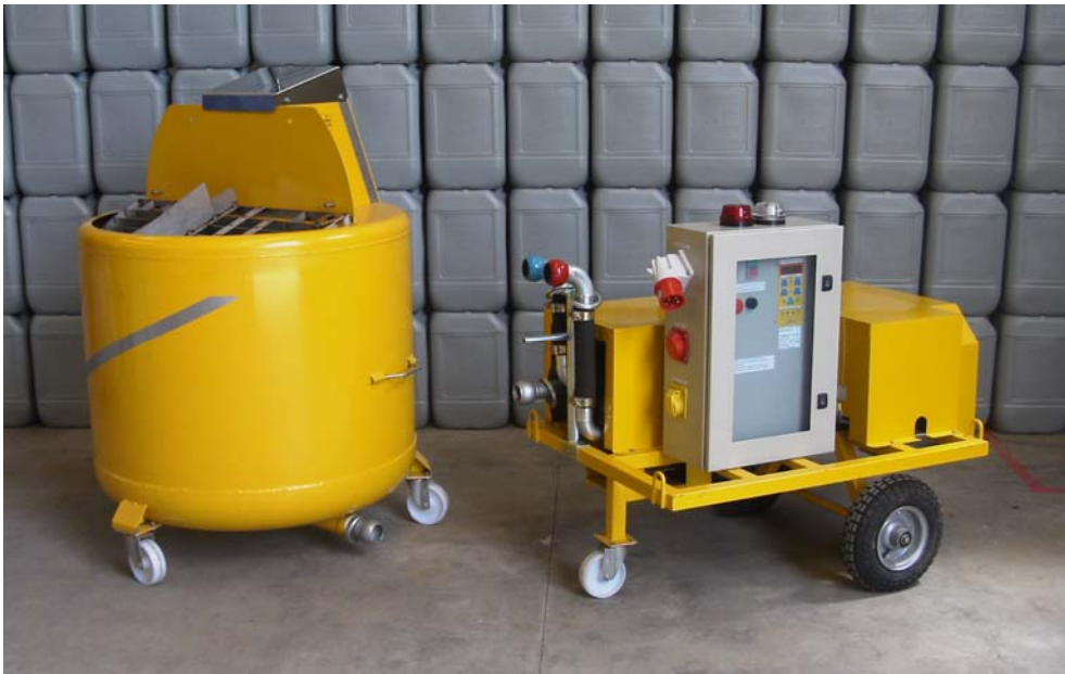
Équipement avec pompe dosage eau.
