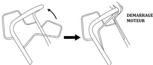
4. De l'autre main, tirer doucement sur la poignée lanceur (Fig. A, 5) qui se retrouve dans son crochet support (Fig. A, 17) jusqu'à la compression (sensation de résistance), puis tirer à fond avec force pour démarrer le moteur.
