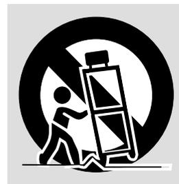
L'ensemble projecteur/chariot doit être manipulé avec précautions. Des arrêts brusques, une force excessive ou des surfaces irrégulières peuvent faire renverser le chariot.
