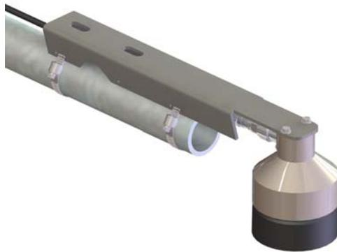
**Figure 5 Monture du SR50A – montée parallèle au tuyau**
