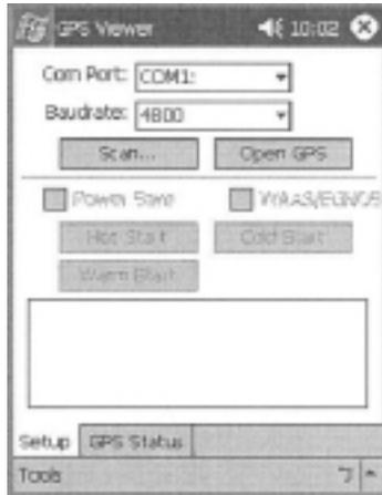
6) Configuration du débit (en bauds) : sélectionnez 9600 dans "Baudrate" et appuyez sur l'icône "Scan" située en dessous pour déterminer le port COM (l'exemple ci-après montre que le port COM de l'IPAQ 3970 est le COM8). Choisissez votre port COM (compris entre COM1 et COM10) et cliquez sur "Open GPS".
