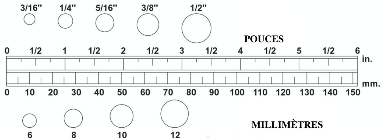
**NOTE:** La longueur de l'ensemble des boulons et des vis, sauf les modèles à tête plate, est mesurée du dessous de la tête à l'extrémité du boulon ou de la vis. Les vis et boulons à tête plate sont mesurés du dessus de la tête à l'extrémité du boulon ou de la vis.
