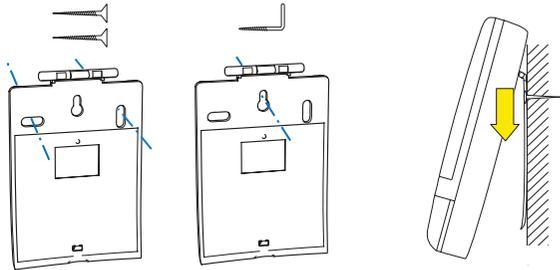
3. Utiliser les trous pour fixer la patte sur le mur
