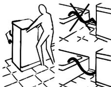
• Raccorder l'extrémité coudée du tuyau d'entrée d'eau à l'électrovanne ( partie supérieure arrière de l'appareil ) et l'autre extrémité au robinet ou la prise d'eau, à l'aide d'un raccord fileté 3/4" gaz.
