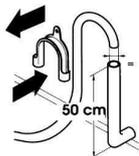
• Rapprocher la machine du mur, en faisant bien attention à éviter tout coude ou étranglement du tuyau, et raccorder le tuyau d'écoulement au rebord de l'évier ou, mieux encore, à un dispositif fixe d'évacuation, au diamètre supérieur au tuyau du lave-linge et au moins 50 cm de hauteur et 75 cm. maximum du sol.
