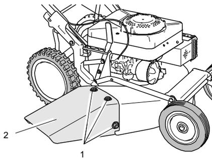
1. Insérer les 3 vis jointes avec un collet carré dans les trous avec une grosse rondelle depuis la face intérieure du carter de l'appareil (1).
