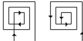
Pour une éjection sans bourrage de l'herbe, il est recommandé de suivre les schémas suivants sur une surface plane. Le mulch sera encore plus fin avec une tonte supplémentaire dans le sens contraire de la première.
