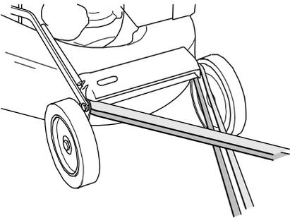
Utiliser des sangles pour bloquer l'appareil.
