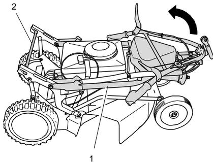
1. Déployer le longeron de guidage (1) vers l'arrière et enclencher le blocage du longeron (2).
