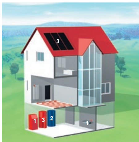
Composants d'un chauffage à gaz 1 Chaudière à gaz à condensation, 2 Chauffe-eau 3 Installation solaire
