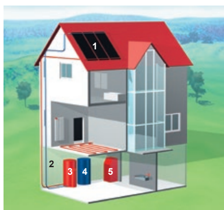
Composants d'un système de production d'eau chaude/assistance au chauffage solaire 1 Capteurs, 2 Conduites, 3 Accumulateur à stratification, 4 Chauffe-eau, 5 Générateur de chaleur supplémentaire
