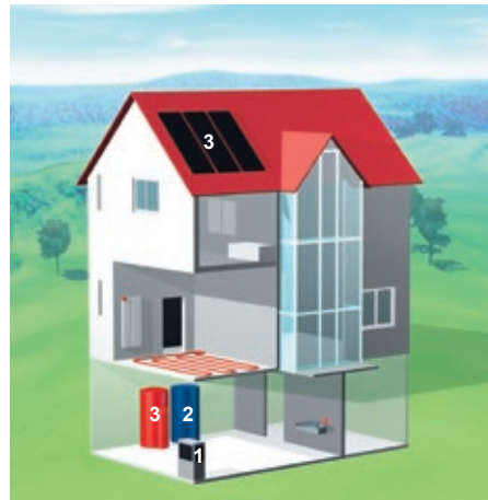
Composants d'une pompe à chaleur air/eau 1 Pompe à chaleur, 2 Chauffe-eau, 3 Installation solaire
