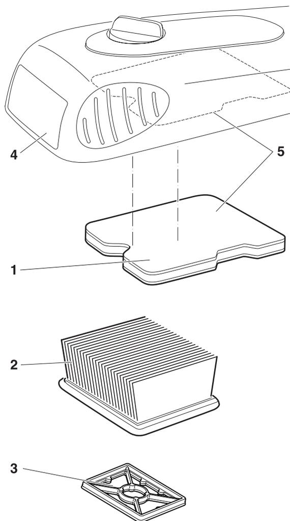
**Pré-filtre (mousse avec huile pour filtre à air)**
