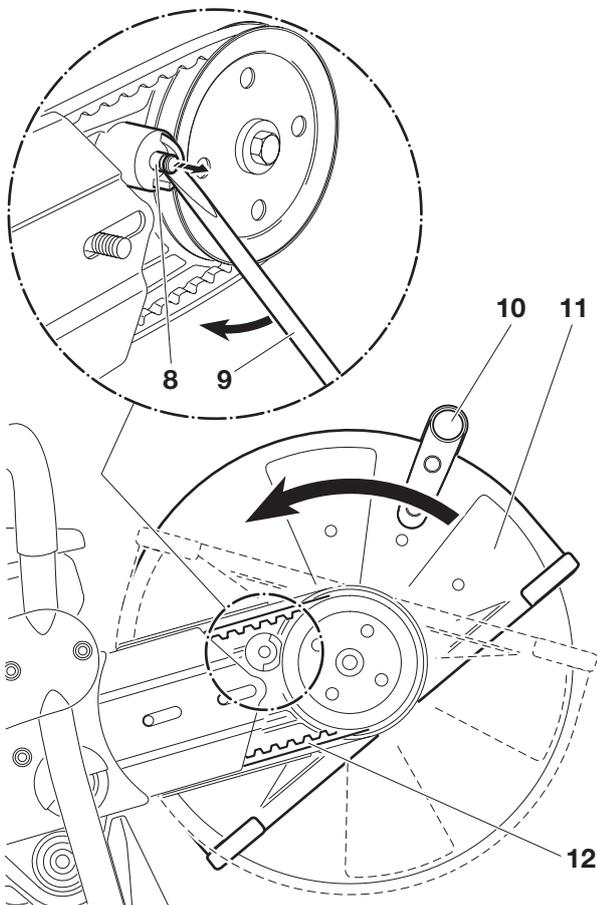
Retirer le boulon de butée (8) en le levant avec la clé universelle (9) comme montré sur la figure jusqu'à ce que le capot de protection (11) puisse être tourné.
