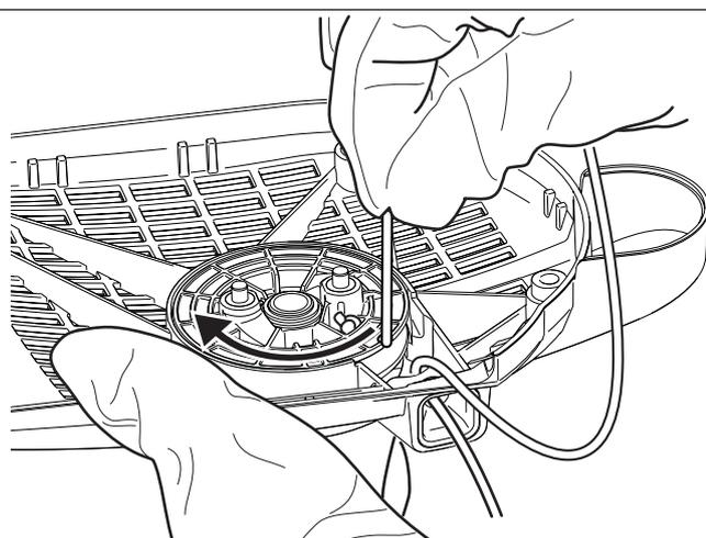
Introduire le cordon dans l'évidement (24) sur le tambour d'enroulement et tourner deux fois le tambour d'enroulement avec le cordon dans le sens de la flèche.
