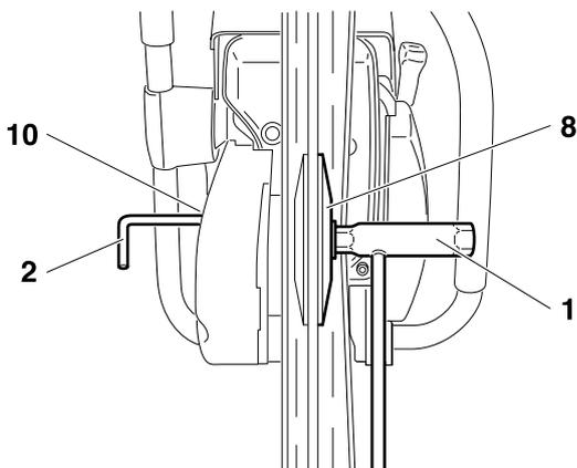
Poser le disque de contrainte (8) sur l'arbre, visser la vis (9) à l'intérieur et la serrer à la main.
