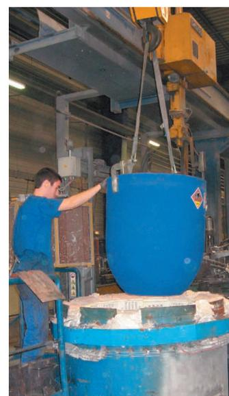
Descriptif : Les 2 pinces dont les mâchoires ont un revêtement antidérapant, sont ajustable par une vis de réglage. Elles soulèvent toutes tailles de creusets dont l'épaisseur de la paroi ne dépasse pas 55 mm et de charge maxi 300 kg.
