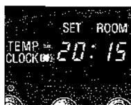
E: Si la lampe témoin CLOCK ne clignote plus, c'est que l'heure désirée est programmée.
