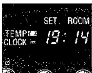
F: A gauche la température désirée, à droite la température mesurée.
