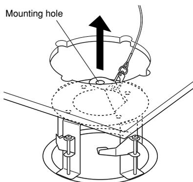
**6. Fixer solidement la platine de fixation au panneau de plafond avec les vis de fixation de panneau de plafond (4 endroits).**
