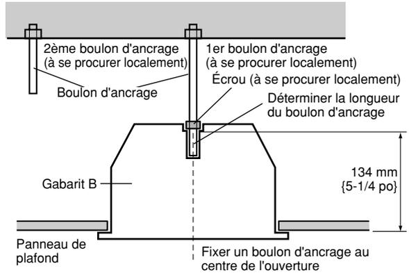
**Remarque:** Si un boulon d'ancrage est déjà installé, le boulon d'ancrage peut être utilisé comme second boulon d'ancrage. S'assurer que la distance entre le 1er et le 2ème boulons d'ancrage est de 1 000 mm {3,28 pd.} ou inférieure avant de l'utiliser.
