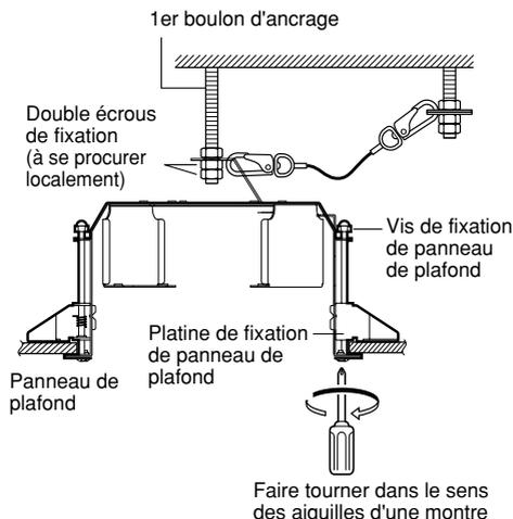
**7. Se servir des écrous de fixation double (à se procurer localement) pour fixer la platine de fixation d'installation de caméra vidéo après avoir introduit le 1er boulon d'ancrage.**
