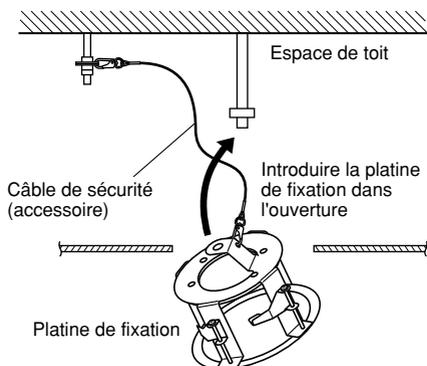
**5. Introduire le boulon du 1er ancrage dans l'ouverture d'installation de la platine de fixation.**
