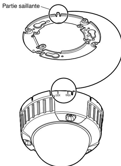
Engager la caméra vidéo sur l'accessoire d'installation de caméra vidéo.
