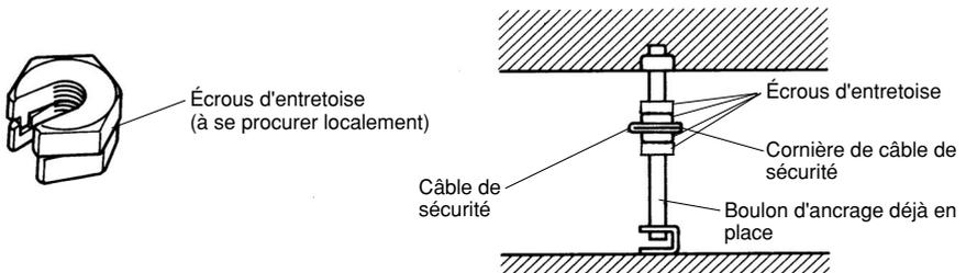
**4. Relier cette platine de fixation à l'extrémité du câble de sécurité.**
