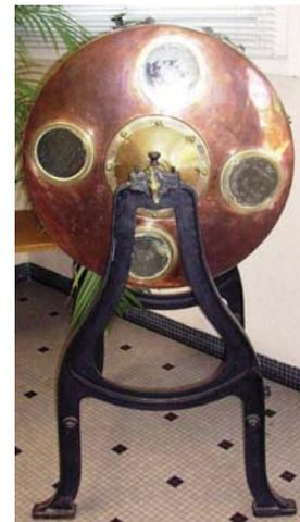
Figure 32: Calorimètre à chien
