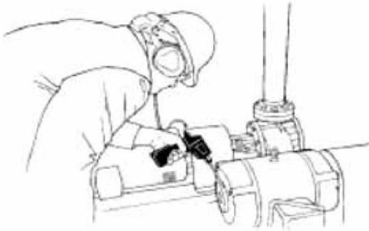
L'inspection et le contrôle des roulements à l'aide des ultrasons est de loin la méthode la plus fiable pour détecter les débuts de défaillance.
