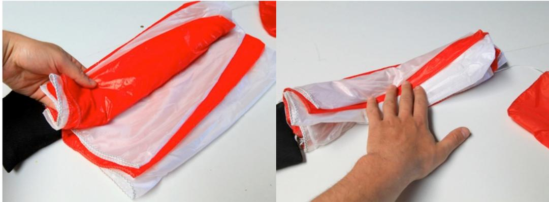
On obtient désormais les panneaux pliés dans la longueur, la prochaine étape consiste à plier le restant à la dimension du Pod. Le pliage doit s'effectuer en 3 plis.
