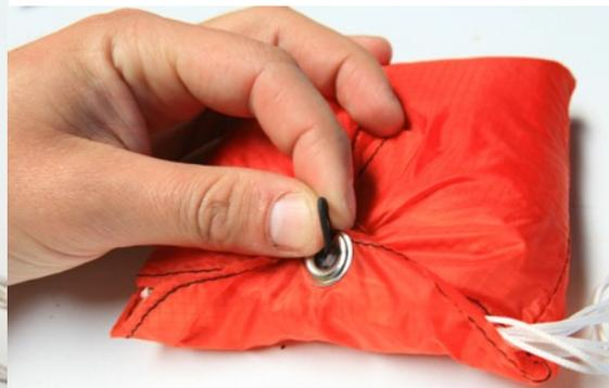
Une fois le volet fermé, passer 3 à 4 suspentes afin de verrouiller l'ouverture.
