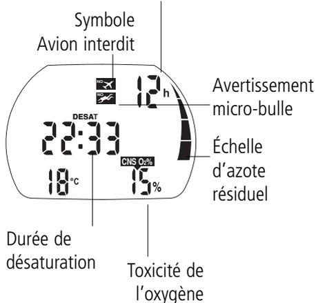
Vous pouvez vérifier le temps de désaturation restant\* à partir de **l'affichage de l'heure** en pressant . La durée de la désaturation est déterminée soit d'après la toxicité de l'oxygène, la saturation en azote ou la diminution des micro-bulles, selon ce qui prendra le plus de temps pour le retour à la normale.
