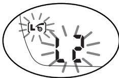
Si le niveau de micro-bulles a été réduit au cours d'une plongée, l'Aladin® TEC va afficher en clignotant le niveau de micro-bulles actuel pendant 5 minutes après le retour en surface. La plongée se termine ensuite, et l'Aladin® TEC repasse en mode « utilisateur » avec retour au niveau de micro-bulles sélectionné à l'origine.
