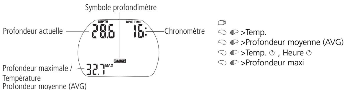
La **profondeur moyenne** est constamment mise à jour et représente la profondeur moyenne en fonction du temps écoulé depuis le début de la plongée (brevet en cours)
