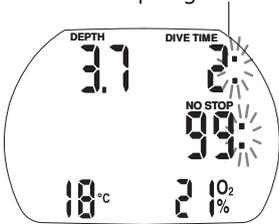
Tout le temps passé en-dessous de 0.80 mètre est comptabilisé comme durée de plongée et affiché en minutes. Le temps passé au-dessus de 0.80 mètre n'est comptabilisé comme durée de plongée que si le plongeur descend au-dessous de 0.80 mètre dans les cinq minutes.
