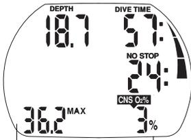
La profondeur maxi n'est affichée que si elle dépasse la profondeur réelle de plus de 1 mètre. Si la profondeur maximum n'est pas affichée, l'Aladin® affichera la température.
