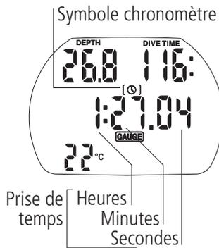
En mode profondimètre, après l'immersion, l'Aladin® TEC va automatiquement activer la durée de plongée ainsi que le chronomètre. Le chronomètre va fonctionner pour un temps maximum d'1 heure et pas plus de 24 heures en immersion.
