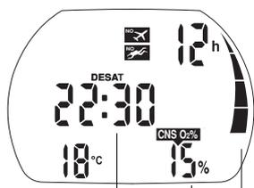
Durée de désaturation | Echelle d'azote résiduel
