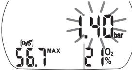
TEC Modifiez la ppO<sub>2</sub> max avec ☹ ☹ (+) et ☺ ☺ (-)
