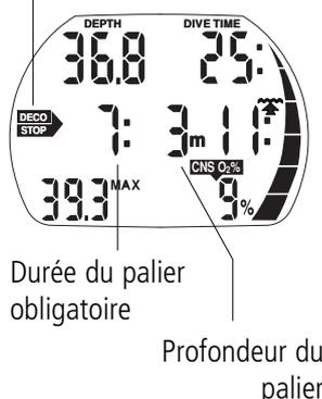
Lorsqu'on entre dans la phase avec palier, NO STOP s'éteint, DECO STOP apparaît et le bip d'attention sonore se fait entendre. L'échelle d'absorption d'azote cesse de clignoter et le 6ème segment se remplit (zone rouge). Le palier le plus profond s'affiche en mètres ainsi que sa durée en minutes. L'indication < 7: 3m > signifie donc qu'il faut effectuer un palier de décompression de 7 minutes à 3 mètres de profondeur.
