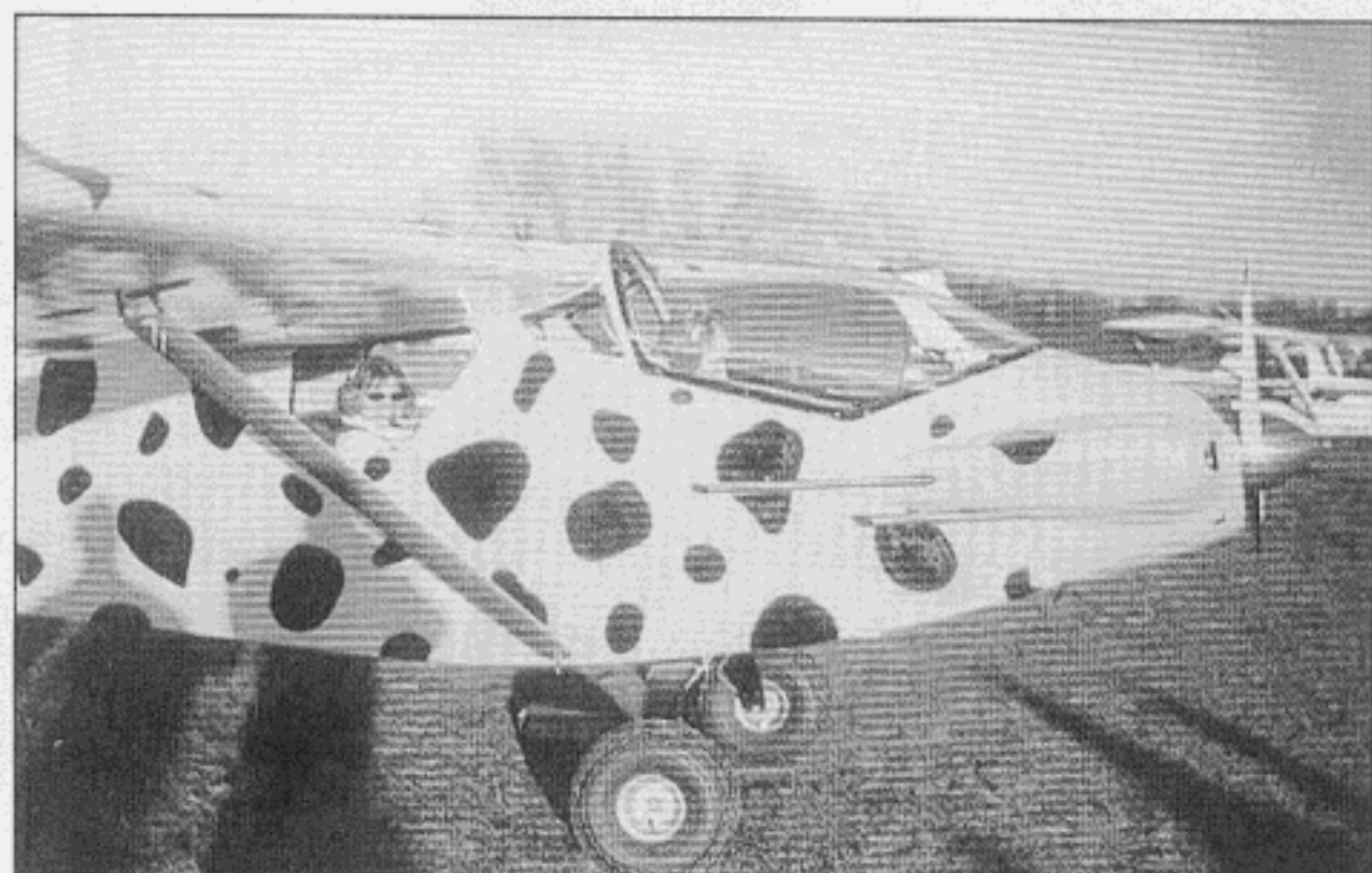
La Souris-Bulle ULM biplace de l'auteur porte de longues pipes d'échappement pour réduire sa signature sonore
