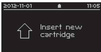
Si la cartouche n'est pas insérée en moins de 30 secondes, la trappe à cartouche se referme automatiquement et l'écran revient à la fenêtre «Run test».
