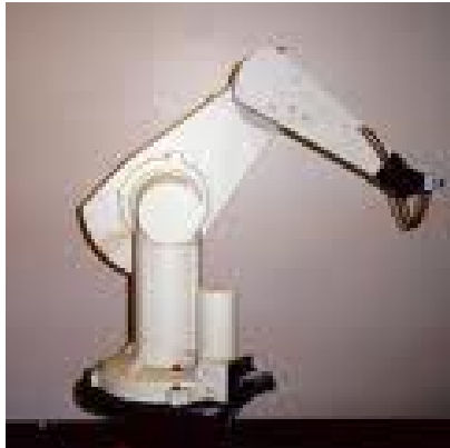
Figure I.2 : Bras de robot PUMA 560
