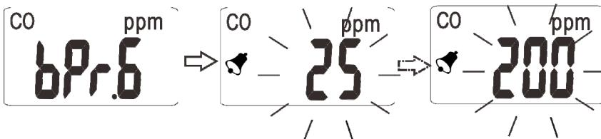
L'avertisseur sonore du seuil d'alarme invite à l'évacuation de la zone en raison de la détection de concentrations dangereuses de CO. L'alarme du compteur retentit lorsque la concentration de CO dépasse les valeurs par défaut du seuil programmé par l'utilisateur.
