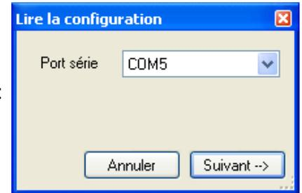
Sélectionner le numéro de port série correspondant au port de configuration du MOES puis cliquer sur suivant. Le message ' Lecture de la configuration ' apparaît puis laisse place au message ' Opération réalisé avec succès '.
