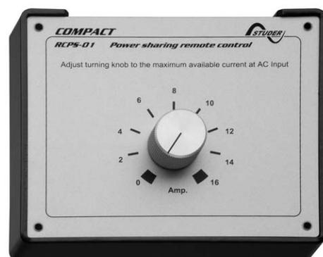
Si se aplica el control remoto RPS-01, el trimmer (26) "INPUT LIMIT" debe ajustarse al valor máximo. El equipo COMPACT tiene en cuenta el más bajo de los valores que han sido ajustados en el aparato y en el control remoto.
