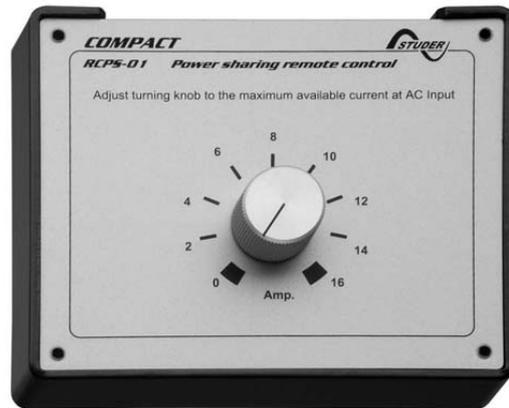
Par exemple si la source est une génératrice de 2000 Watt, le potentiomètre doit être réglé sur 8A max.. Cette valeur est obtenue en divisant 2000 Watt par 230V.
